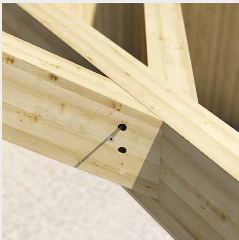
^ Gerenda-világítóablak kötés 8 mm átmérőjű HBS - sel.
